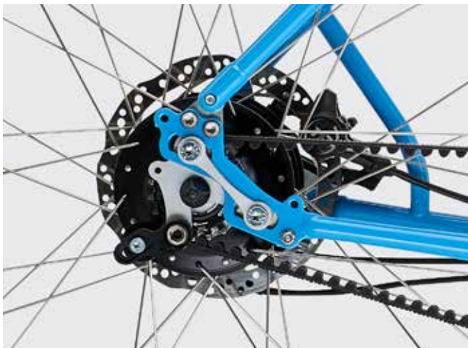
VERSTELLBARES AUSFALLENDE DISC ONLY MIT RIEMENSCHLOSS
