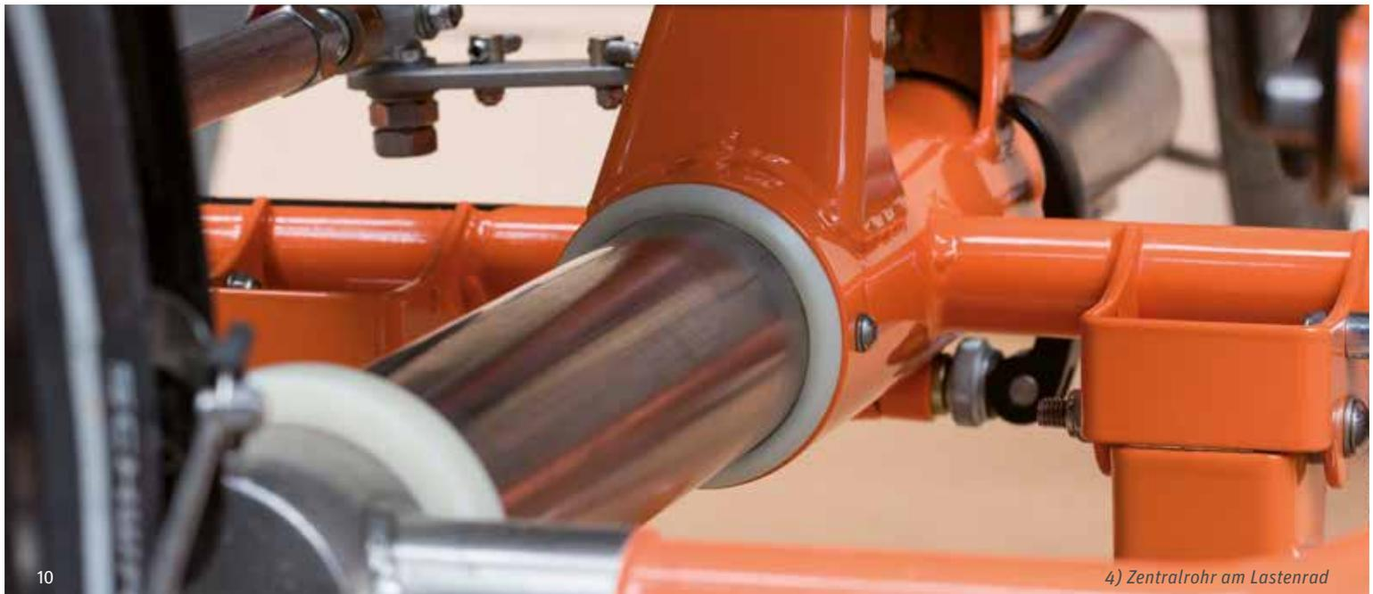
4) Zentralrohr am Lastenrad
